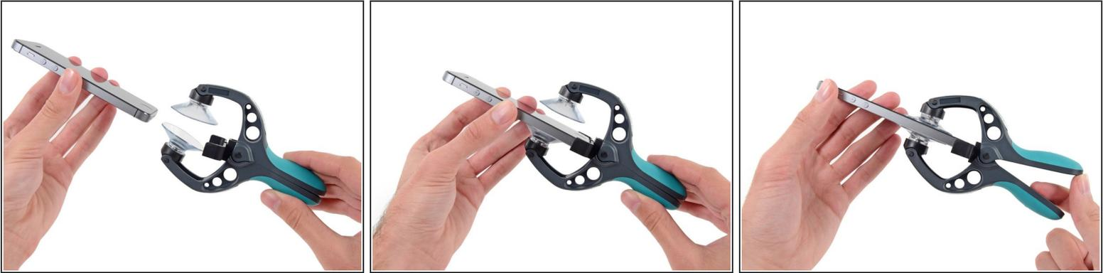
**i** Die nächsten zwei Schritte zeigen, wie man den , verwendet. Ein großartiges Werkzeug, um das iPhone 5s sicher zu öffnen, das wir für jeden empfehlen, der mehr als eine Reparatur durchführen will. "Wenn du den iSlack nicht verwendest, gehe weiter zu Schritt 5."
